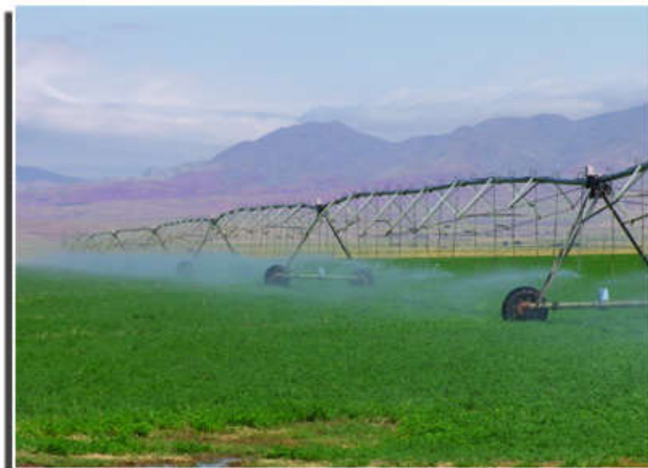
تصویر ۱۱ آبیاری بارانی به روش دوار مرکزی و خطی (سنتر پیوت یا لینیر)
