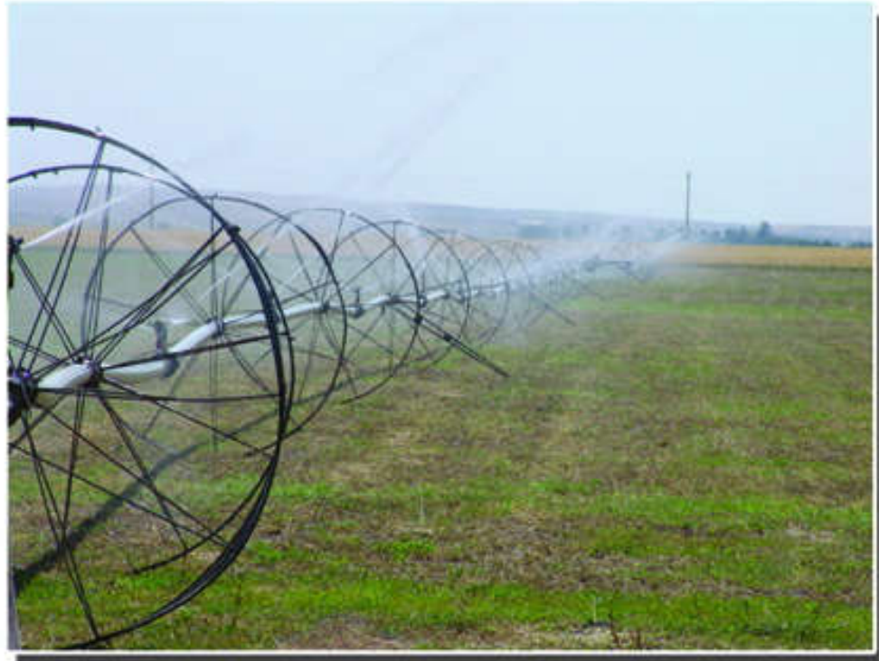
تصویر ۱۰ آبیاری بارانی از نوع چرخ دوار یا ویلمو
